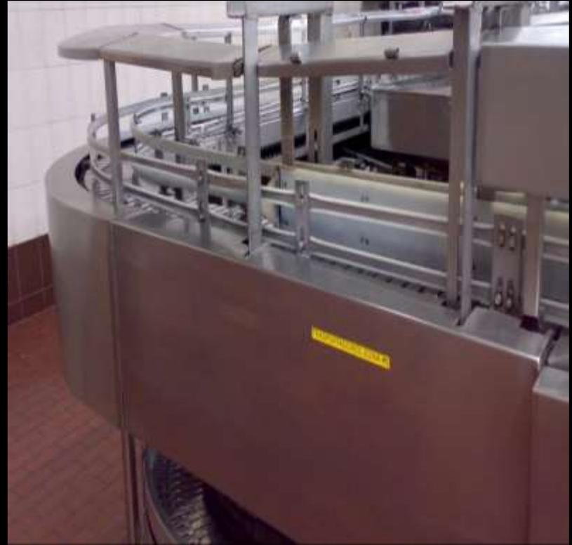
MEDIAS CAÑAS DE  $\frac{3}{4}$  DE ACERO INOXIDABLE TIPO 304. SIRVEN COMO GUÍAS DE BOTELLAS EN TRANSPORTADORES DE CADENA Y EVITAR DESGASTE DE BOTELLAS DE VIDRIO.
