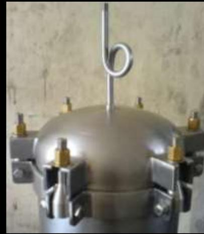
FILTRO PULIDOR. ES FABRICADO EN ACERO INOXIDABLE TIPO 304, PARA 9 CARTUCHOS DE 5 MICRAS, PARA SER USADO EN FILTRADO DE AGUA Y ELIMINAR PARTÍCULAS, CARTUCHOS INTERCAMBIABLES FÁCILMENTE.
