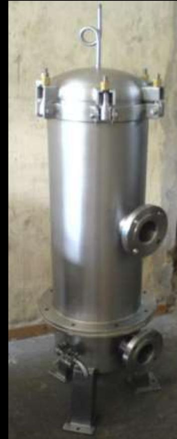
FABRICADO EN ACERO INOXIDABLE TIPO 304, CON TUBO DE 3" BARRENADO PARA APOYO DE MALLA (SEDADO). ESTE FILTRO SE UTILIZA EN RECIRCULACIÓN DE AGUA DE ENJUAGUES DE LAVADORAS DE BOTELLAS Y GARRAFONES, PARA ATRAPAR RESIDUOS Y ASÍ EVITAR SE TAPEN LAS ESPREAS.
