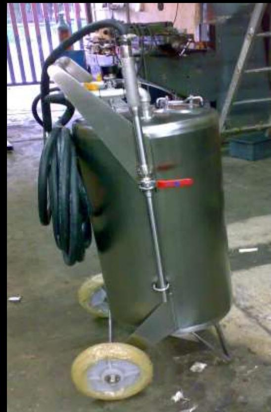
DE ACERO INOXIDABLE TIPO 316 CALIBRE 16 CON CAPACIDAD DE 64 LT. CON LLANTAS SANITARIAS Y PISTOLA DE APLICACIÓN, CON 10 MT. DE MANGUERA PARA AIRE Y PISTOLA.
