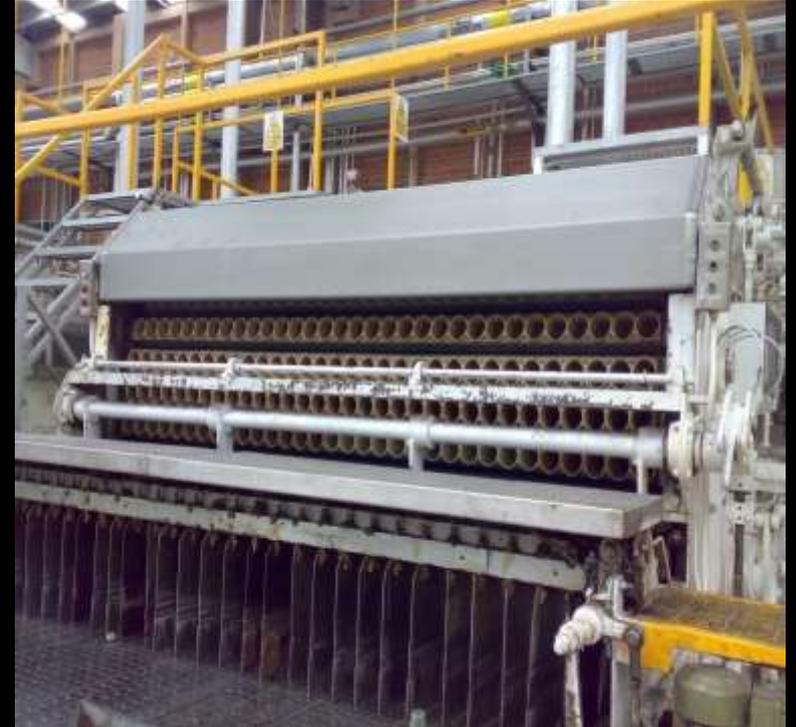
CANJILÓN PARA LAVADORA DE BOTELLAS. CON EXTREMOS DE ACERO INOXIDABLE Y SOLDADO POR DENTRO Y POR FUERA CON GAS ARGÓN (REFORZADO).
