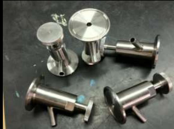
VÁLVULAS DE MUESTREO TIPO SANITARIO CLAMP  $\frac{3}{4}$ " Y 1".
