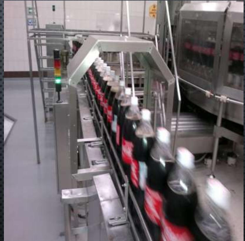
TÚNEL DE ENJUAGUE, FABRICADA CON LÁMINA DE ACERO INOXIDABLE CAL. 16 PULIDA CON VENTANAS DE ACRÍLICO DE 6 MM
