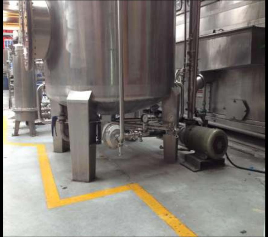
TANQUE CON CAPACIDAD DE 2,300 LITROS APROX. EN ACERO INOXIDABLE TIPO 316 CON INYECCIÓN DE OZONO EN LA PARTE BAJA POR MEDIO DE VENTURY.
