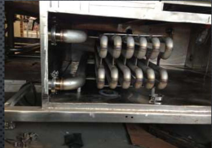
SERPENTINES PARA VAPOR CON TUBO DE ACERO INOXIDABLE PARA INTERIOR DE LAVADORAS DE BOTELLAS. CALENTAR SOSA.
