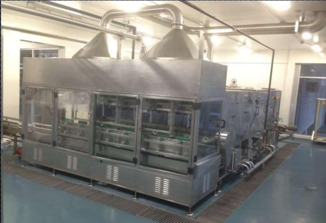
CAMPANAS Y DUCTOS PARA EXTRACCIÓN DE VAPORES , Y PARRILLAS.
